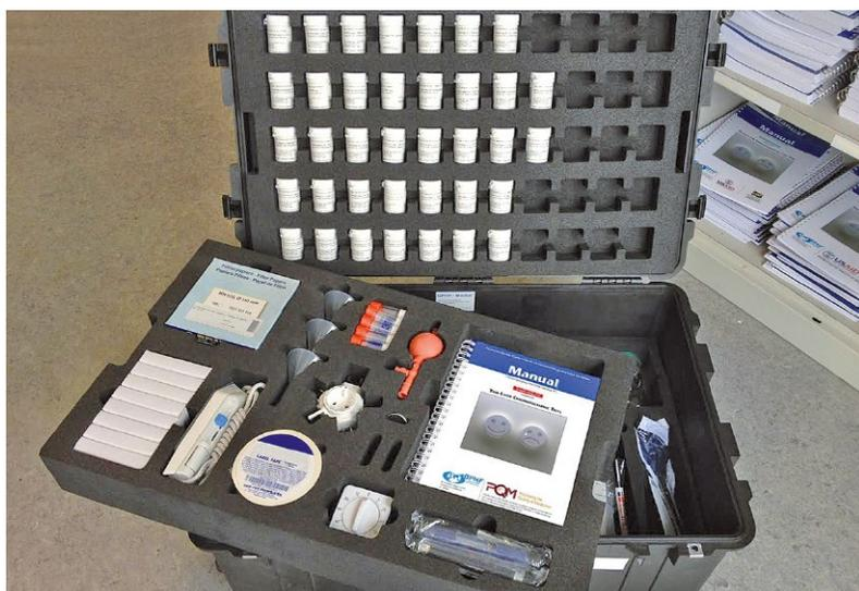
Abb. 1 GPHF-Minilab<sup>®</sup> – ein komplettes Labor in einem Koffer.
